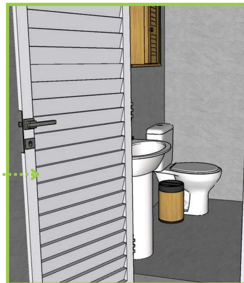
O banheiro permaneceu com todas as suas instalações hidrossanitárias originais, a porta metálica venezianada para auxiliar na ventilação, visto que a janela também foi mantida para dentro da lavanderia. E para ganhar um pouco mais de espaço esta porta tem abertura para fora na circulação que permite maior privacidade.
