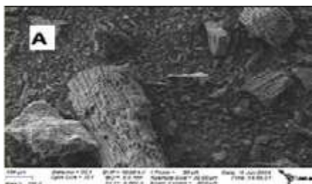
Figura 1: MEV com ampliação de 100x do biochar macerado.
