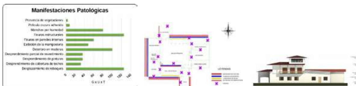
Figura 2. Patologías registradas aplicando metodología GUT en patrimonio Gresfi
