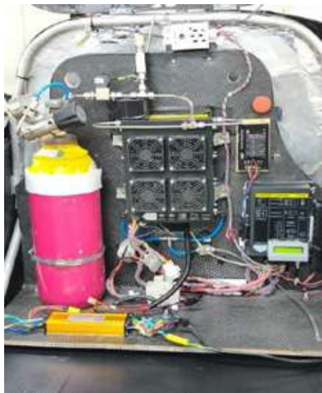
Figura 1: Bancada de célula PEM instalada em um veículo de competência universitária
