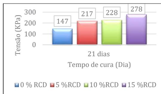
Figura 1. Resistência a compressão dos corpos de prova
