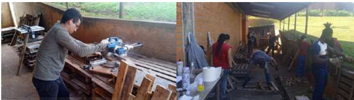
Figura 1. Etapas de desmontagem dos paletes e corte de peças
