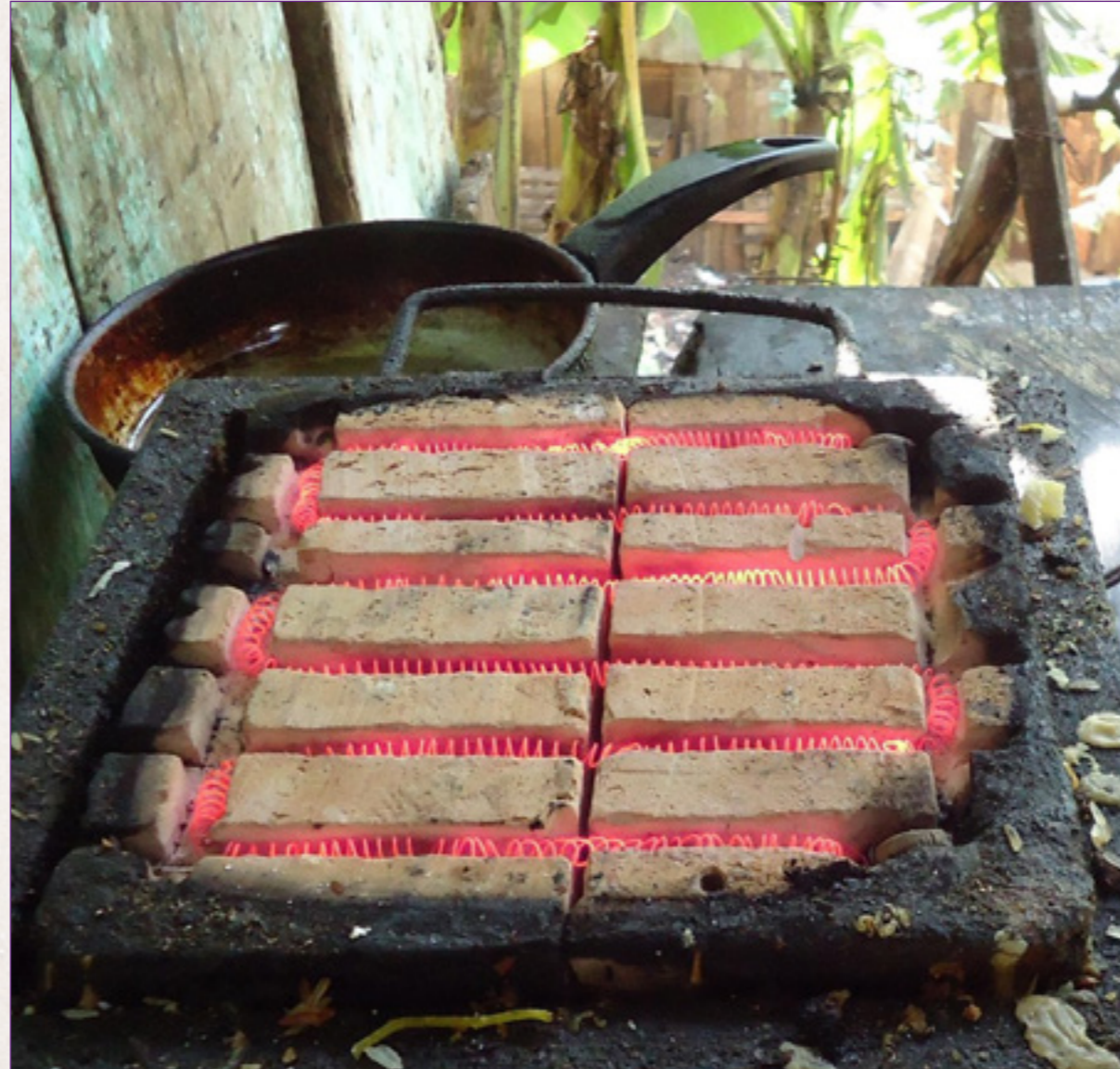
Detalhe de fogareiro elétrico, comum em Ciudad del Este. De fabricação artesanal, com o uso da resistência de chuveiro incrustada numa pedra, esta solução simples diminui o risco de incêndio em zonas altamente adensadas com construções de madeira.
